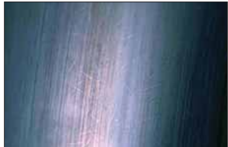
Figura 18 - Impressões na pista de rolagem do anel externo, proveniente do repasse das esferas
