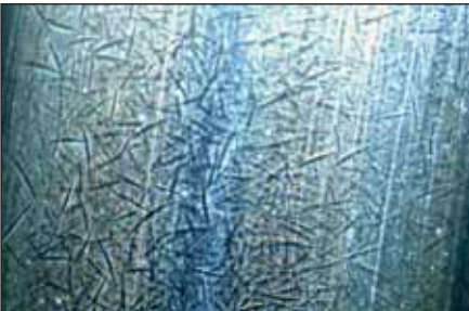
Figura 17 - Impressões na pista de rolagem do anel interno, proveniente do repasse das esferas
