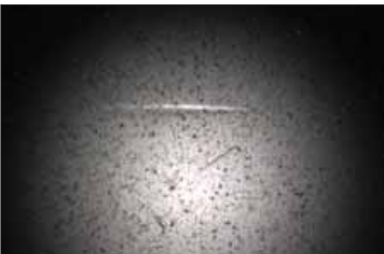
Figura 19 - Esmagamento superficial das esferas
