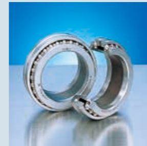
複式スラストアンギュラ玉軸受 NSK TAC D シリーズ 接触角 60° の高剛性スラストアンギュラ玉軸受。アキシャル剛性が向上。分離タイプ。
