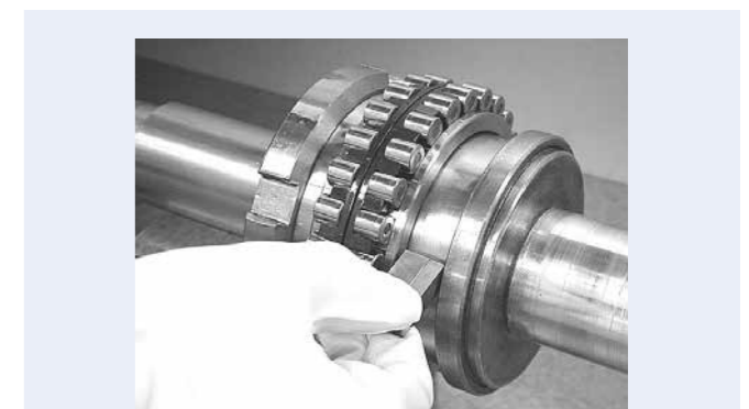
図 1.6 必要間座幅寸法の測定
