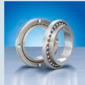
スラストアンギュラ玉軸受 NSK TAC F シリーズ 接触角 50° の高剛性スラストアンギュラ玉軸受。アキシャル剛性が向上。
