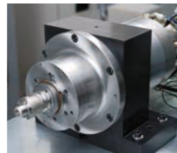
セラミックス球軸受を用い、 d_m n 400万を達成したNSKスピンドル
