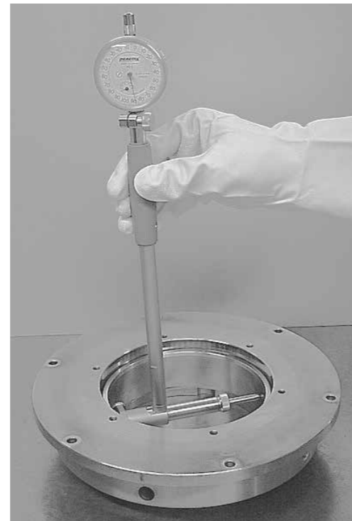
図 1.8 シリンダゲージの 0 点設定
