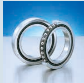
高速スラストアンギュラ玉軸受 BTR10 系列 接触角 40° のスラストアンギュラ玉軸受。高剛性と低発熱性を両立。
